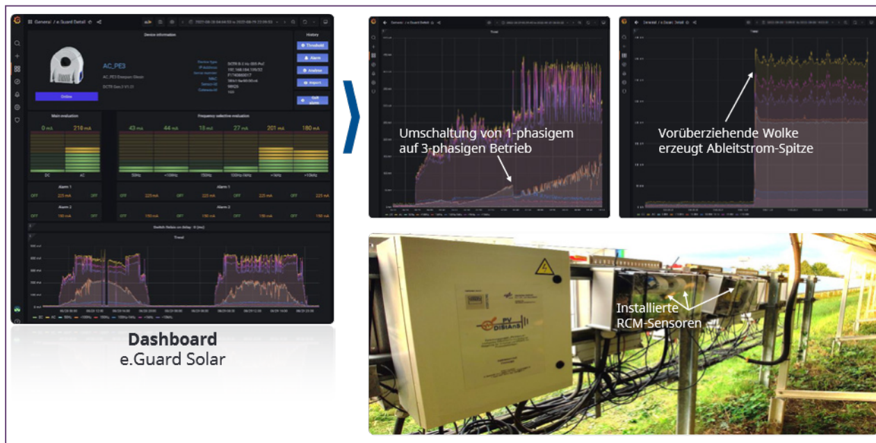
Abbildung 3: Überwachung von PV-Anlagen, Darstellung des Dashboard: Kritische Zustände führen zur Alarmierung
